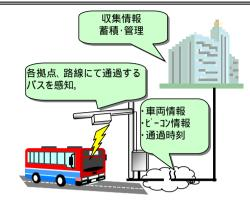
MOCS(Mobile Operation Control Systems) : 光ビーコンを利用した車両運行管理システム PTPS(Public Transportation Priority System): 公共車両優先システム
