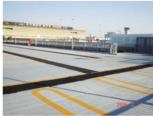
立体駐車場（左：1F アスファルト、右：2F 鉄板床材）
